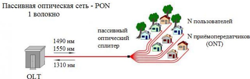
Рисунок 1. Условная архитектура PON
