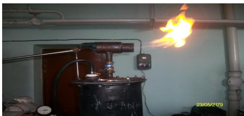
2-сурет. Газды форсункадан тұтану фототүсірілімі
